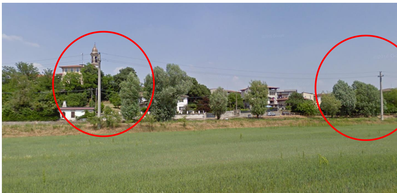
Figura 23. Linea MT interferente (lato destro torrente Cherio). In rosso i sostegni da traslare.
